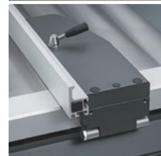
CNCリップフェンス自動位置決め 最大設定寸法1000mm
